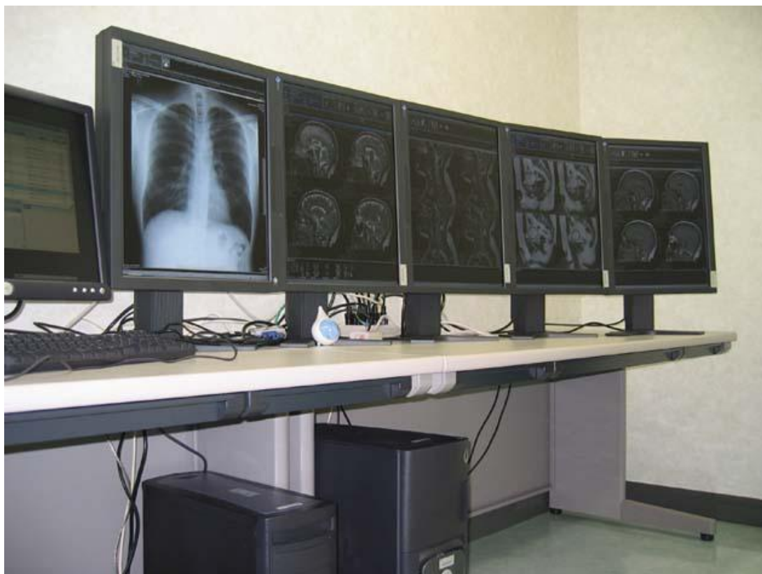
(写真) 5Mの高精細が1面と、2Mの4面が同期表示できるPACSの端末モニタ
