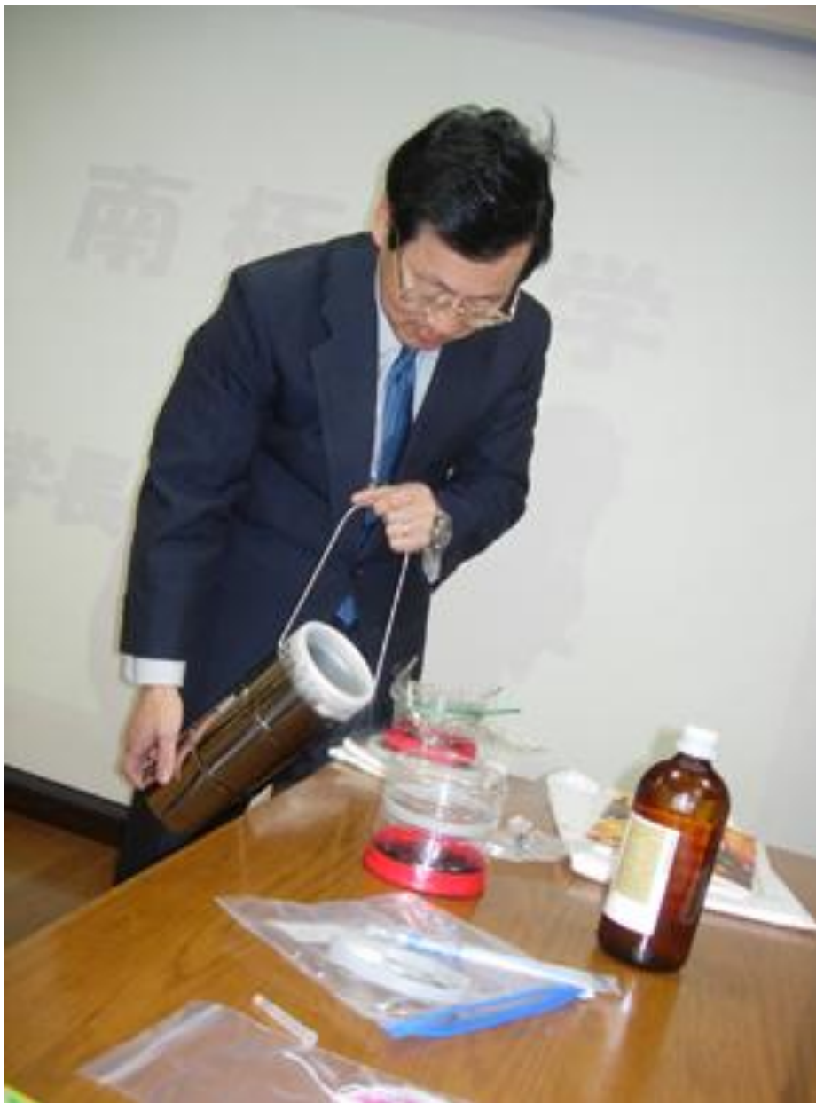
写真2 霧箱に液体窒素を注ぐ筆者。真ん中にペットボトルで作った霧箱、その横にエタノールのビン、手前にシリンジ、ランタン用マンツルのラドン線源がある。小林正幸隊員（通信）が、2005年4月4日に第1回南極大学のとき撮影した。
